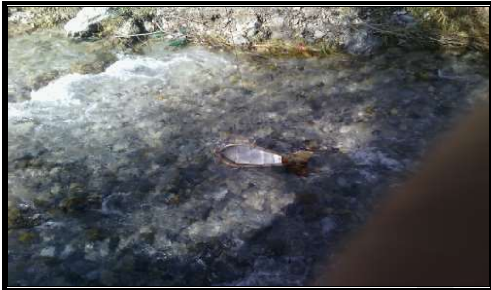
طرح سد رودبار لرستان - نمونه برداری بارکف توسط دستگاه هلی اسمیت
