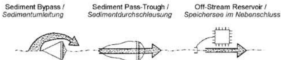
شکل ۱: برخی از انواع دفع رسوب از سد: بای پس، انتقال از داخل بدنه سد، خروج و نگهداری رسوب
