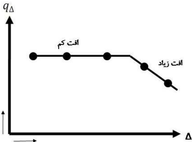
شکل ۵-۲۲: افت و دبی مخصوص در سفره‌های تحت فشار
