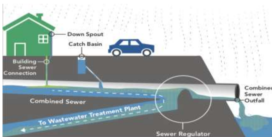
شکل ۲: سیستم ترکیبی دفع رواناب و فاضلاب شهری
